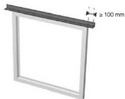
Figure 11 : Pose avec débordement
