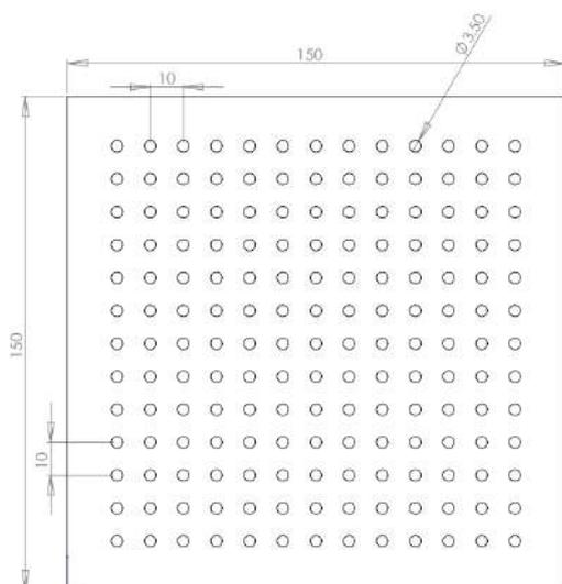
Perforation R3.5U10 >  $\varnothing 3.5\text{mm}$  pour le poinçon et entraxe de 10mm (voir schéma ci-contre).
